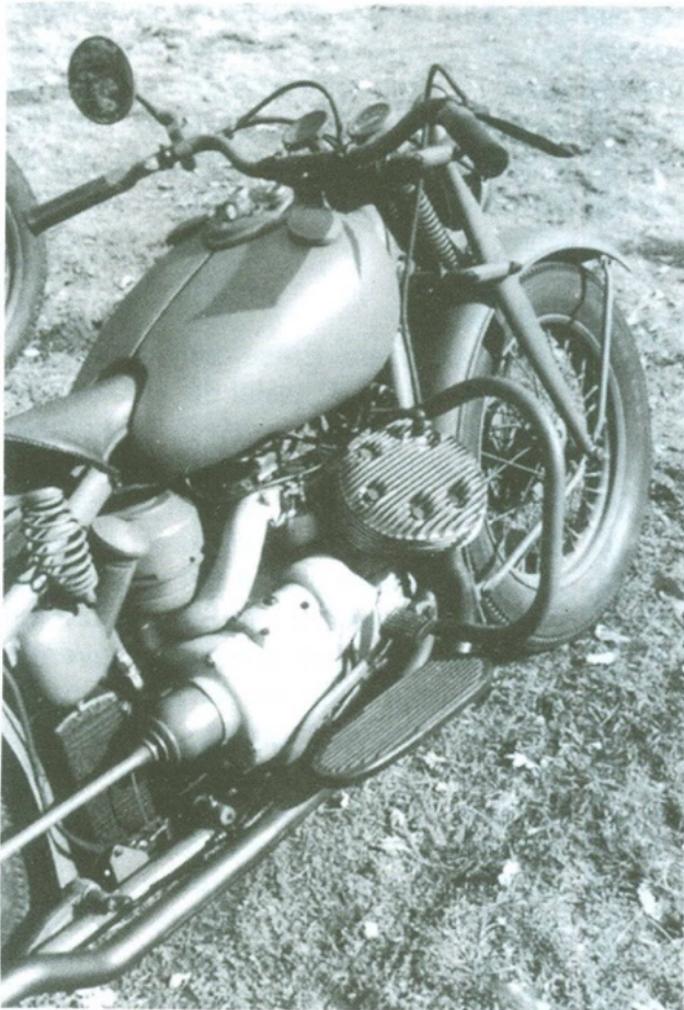
Van de 841 met zijn dwarsgeplaatste 750 cc V-twin en cardanaandrijving werden slechts 1056 exemplaren gemaakt.
